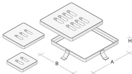
Botola a caditoia in acciaio e cemento armato completa di controtelaio in acciaio zincato.
